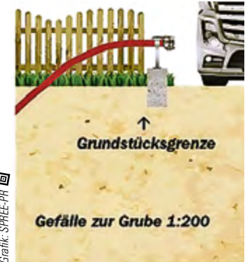
Saugleitung DN 100 für abflusslose Sammelgrube.
